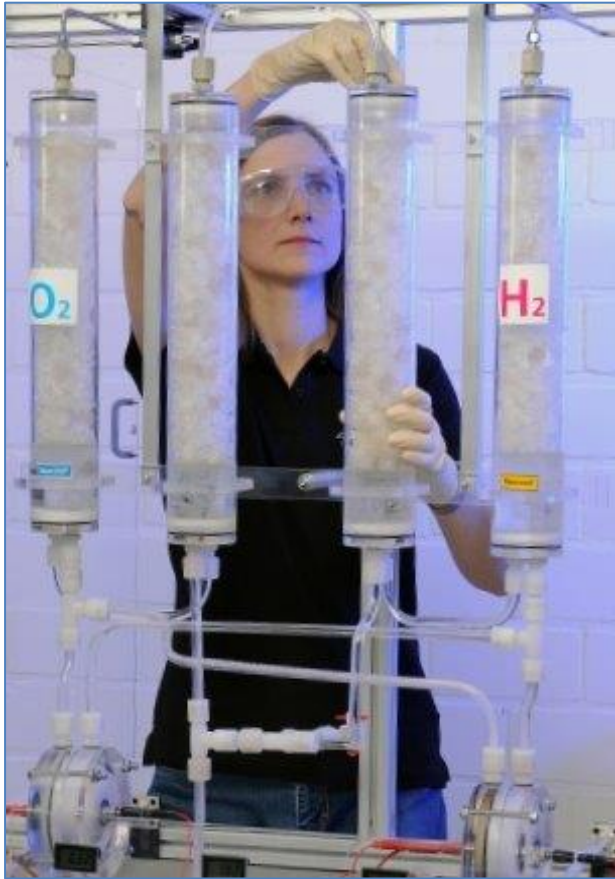
Elektrolyse-Teststand mit im DLR entwickelten Elektroden für die alkalische Wasserelektrolyse. Die DLR-Forscher arbeiten an effizienteren Verfahren zur Herstellung von Wasserstoff durch die Elektrolyse.
