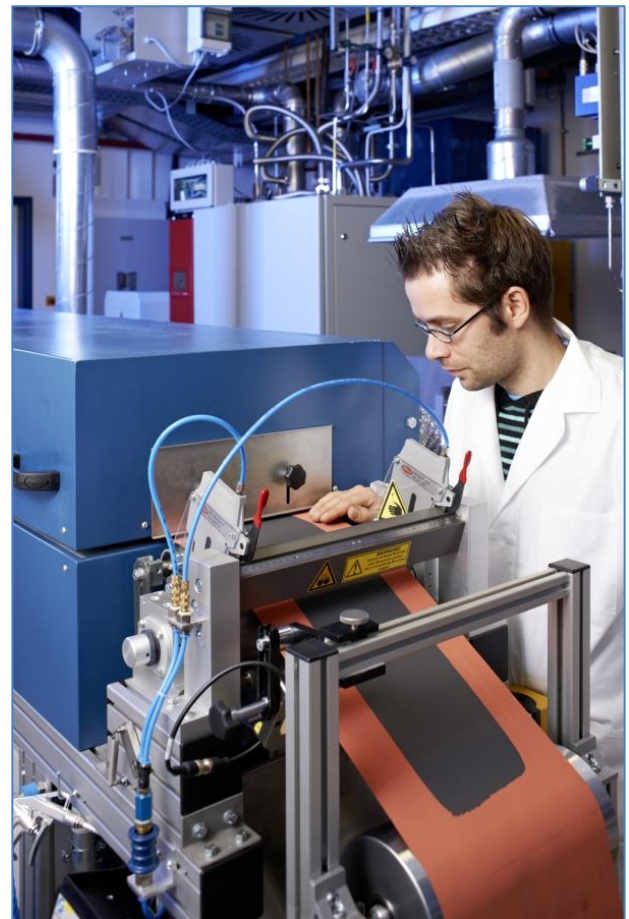
Beschichtung von Elektroden im Rolle-zu-Rolle-Verfahren: Die Forscher haben jetzt das Design von Anode und Kathode für Lithium-Schwefel-Batterien optimiert.
